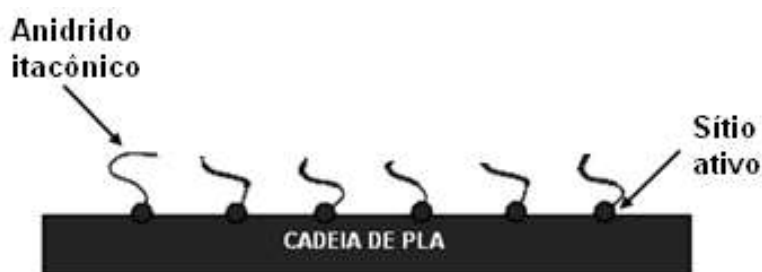
Figura 7- Ilustração da enxertia do anidrido itacônico nos sítios ativos da cadeia do PLA.
