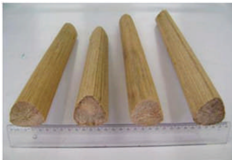
Figura 12 - Pecíolo de buriti (bioespuma).
