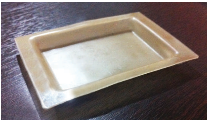
Figura 52 - Protótipo de bandeja obtido por termoformagem com PLA/PB5%.
