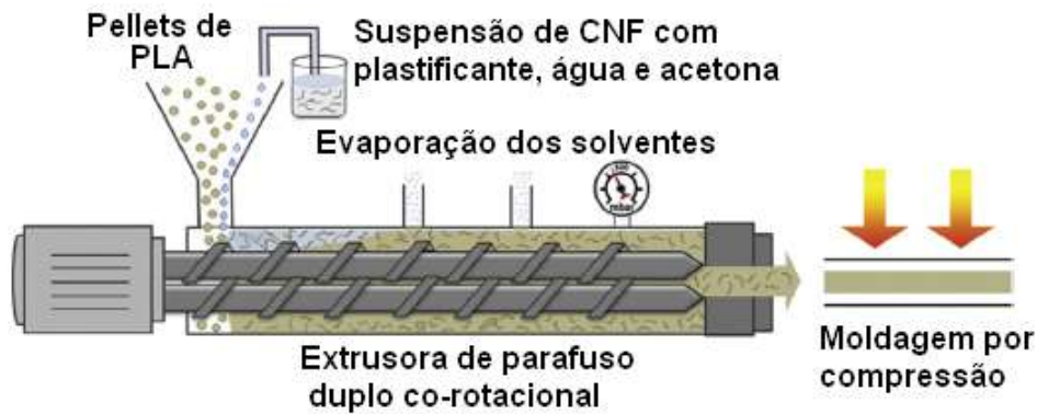
Figura 29 - Ilustração esquemática do processo de extrusão com alimentação líquida.
