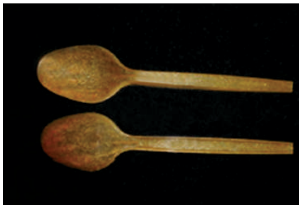
Figura 16 - Protótipo desenvolvido para talheres biodegradáveis de PLA/fibra de banana tratada com silano/argila Cloisite 30B.
