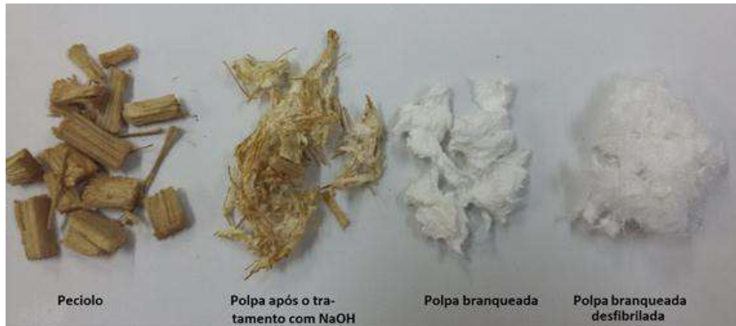
Figura 54 - Fotografia ilustrativa do aspecto visual do PB durante as etapas do branqueamento.
