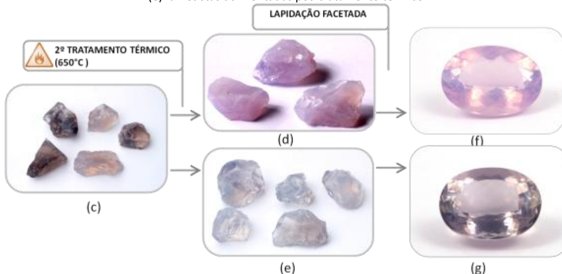
Figura 48: Etapas finais de beneficiamento de ametistas de Brejinho das Ametistas (BA), (d): ametistas leitosas, (e): ametistas acinzentadas pós-tratamento térmico
