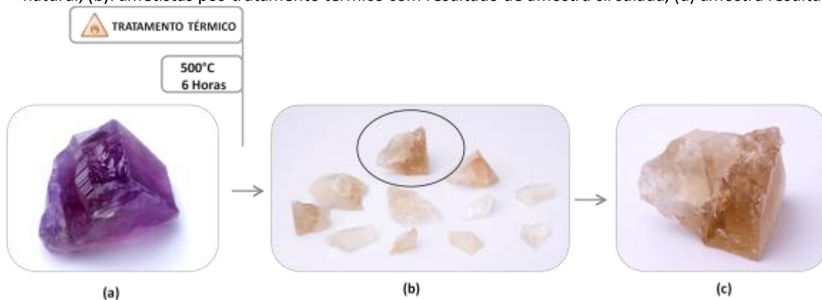
Figura 50: Sequência de etapas de aquecimento de ametistas de Brejinho das ametistas (BA), (a): ametista natural, (b): ametistas pós-tratamento térmico com resultado de amostra circulada, (d) amostra resultante
