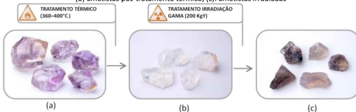
Figura 47: Etapas iniciais de beneficiamento de ametistas de Brejinho das Ametistas (BA), (a): ametista naturais, (b) ametistas pós-tratamento térmico, (c): ametistas irradiadas
