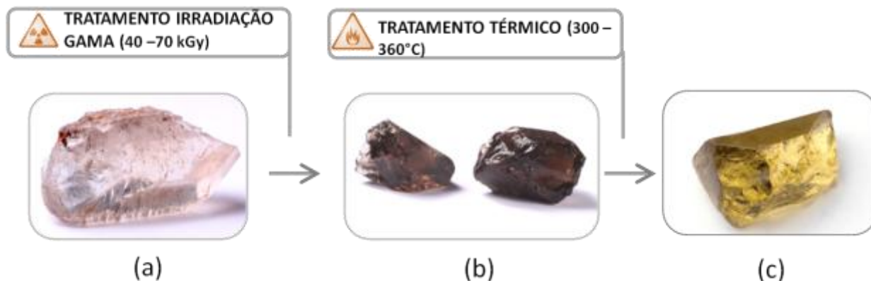
Figura 36: etapas de tratamento em quartzo incolor do Pará para coloração oliva, (a) quartzo incolor do Pará, (b) quartzo fumê, (c) quartzo Green gold
