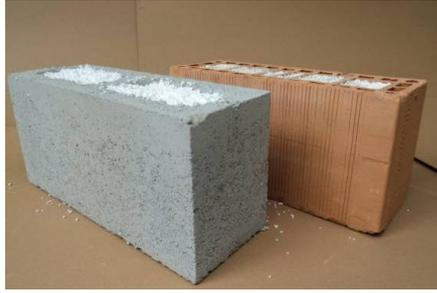
Depois da secagem, as amostras foram preparadas em pares para o teste e transportadas para o Laboratório Integrado de Modelagem, Prototipagem e Ensaio Universais (LEMP) da Escola de *Design* da Universidade do Estado de Minas Gerais. A montagem utilizada para os ensaios foi composta de blocos vazios sobre blocos preenchidos com EPS, variando o tipo de bloco (cerâmica/concreto), conforme FIG. 30 e 31.
