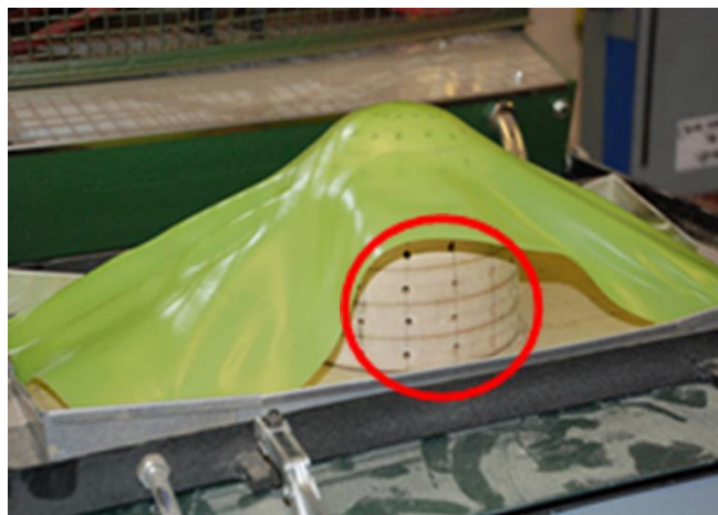
FIGURA 6 - Furos para ventilação
