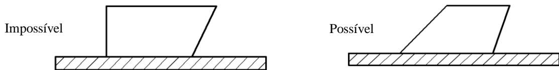
FIGURA 5 - Corte negativo e ângulo de extração
