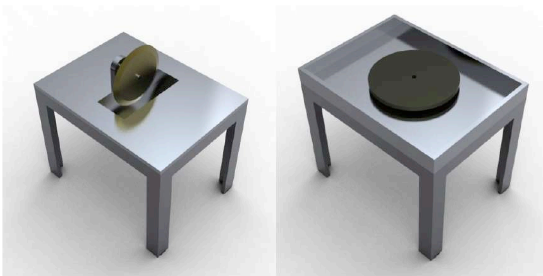
Figura 46 - Representação esquemática da estrutura básica e posicionamento dos discos nos equipamentos com disco vertical e equipamentos com disco horizontal, respectivamente.
