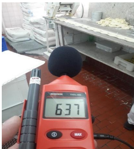
Figura 39 – Medição de luminosidade após a adequação.
