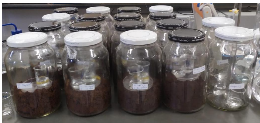
Figura 2 - Microcosmos montados em frascos de vidro transparente contendo solo + biocarvão com teor de umidade de 60%.
