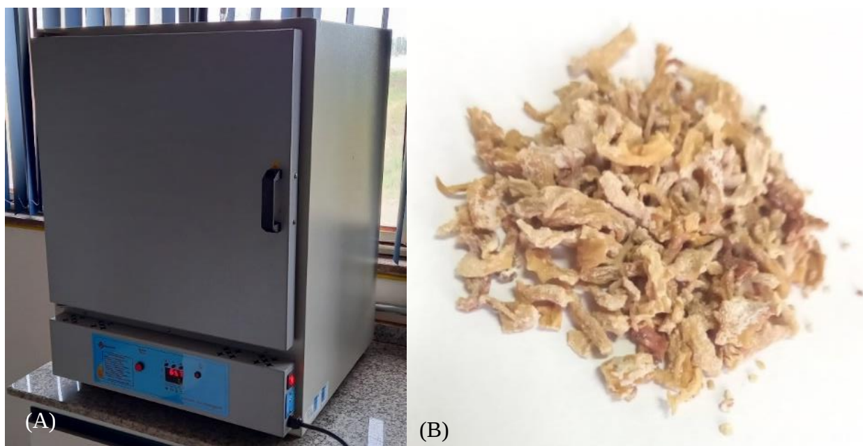
Figura 10 – Secagem das amostras de alga (B) em Estufa de circulação forçada (A)
