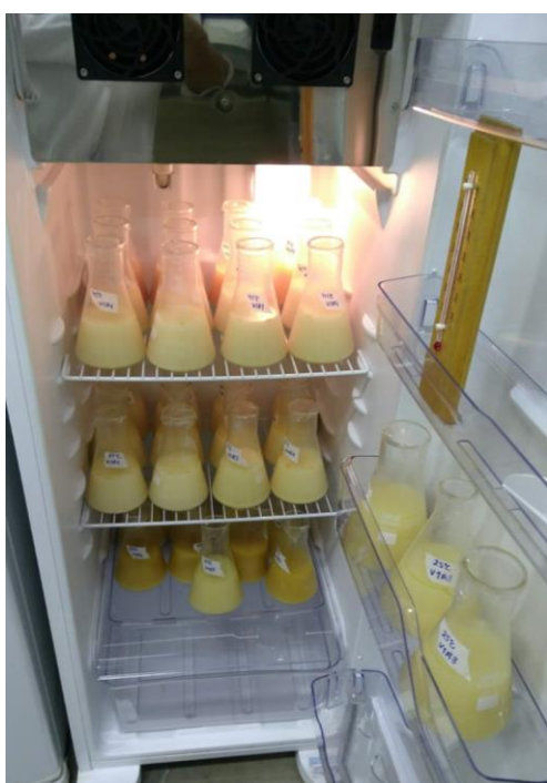
Figura 1 – Fermentação. A) B. O. D. B) – Sacarímetro (°Brix=0)
