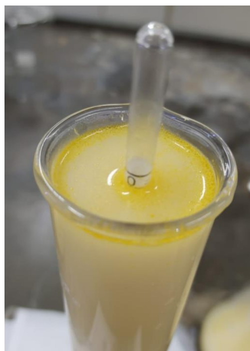
Figura 1 – Fermentação. A) B. O. D. B) – Sacarímetro (°Brix=0)
