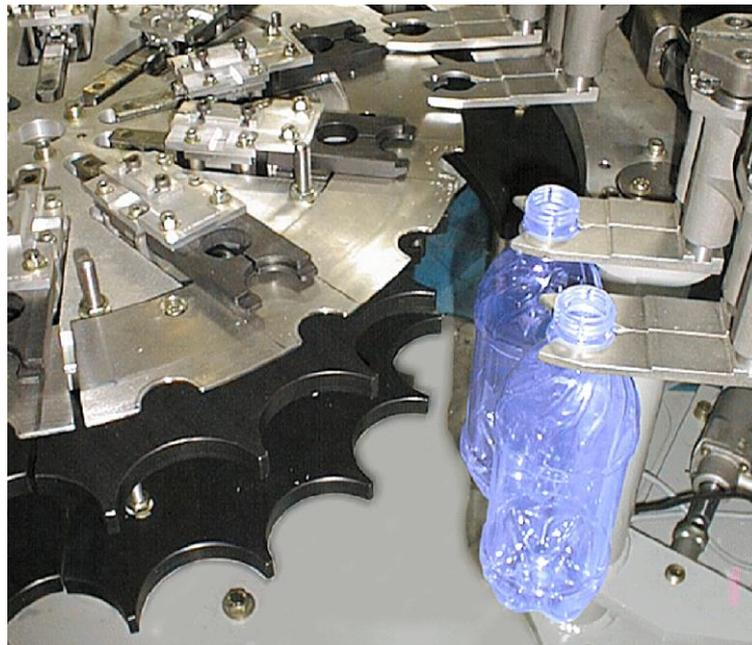
**Figura 11** - Retirada das garrafas sopradas
