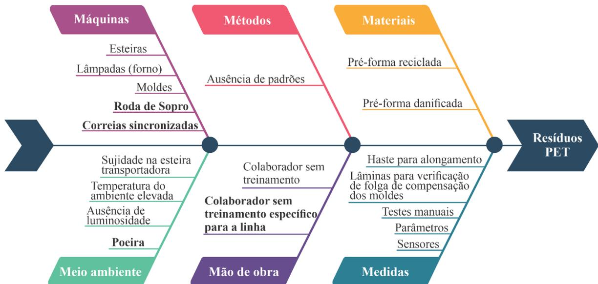
**Figura 17 - Diagrama de Causa e Efeito (Sopro) | Durante da Intervenção**
