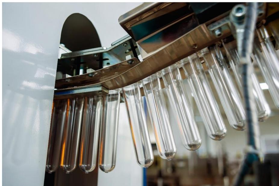
**Figura 7** - Alimentação da máquina com as Pré-formas de PET
