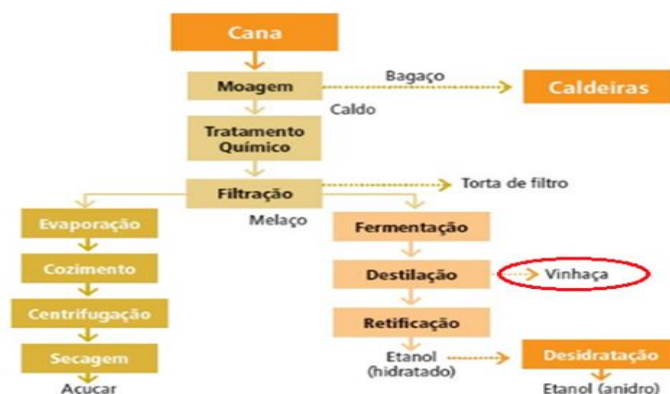
Figura 3 – Fluxograma do processo de produção do etanol e açúcar.
