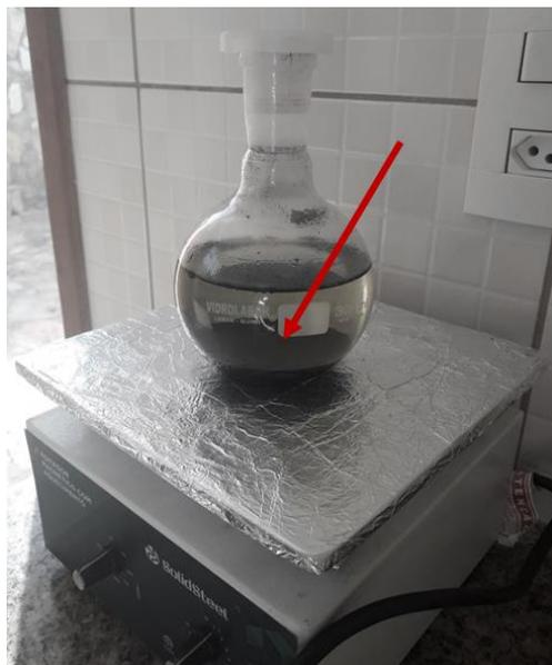
Figura 38 - Sílica derivada de cinza de casca de arroz logo após a lixiviação com HCl.
