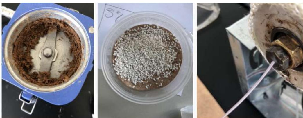
Figura 27: Etapas do processamento dos compósitos de PLA/Fibra de açaí
