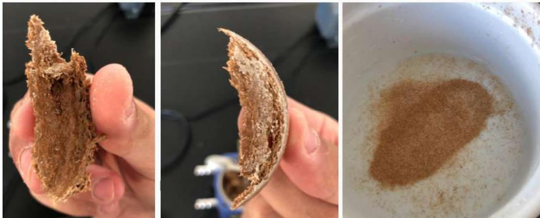
Figura 36: Resultado da mistura de PEG com as fibras de açaí
