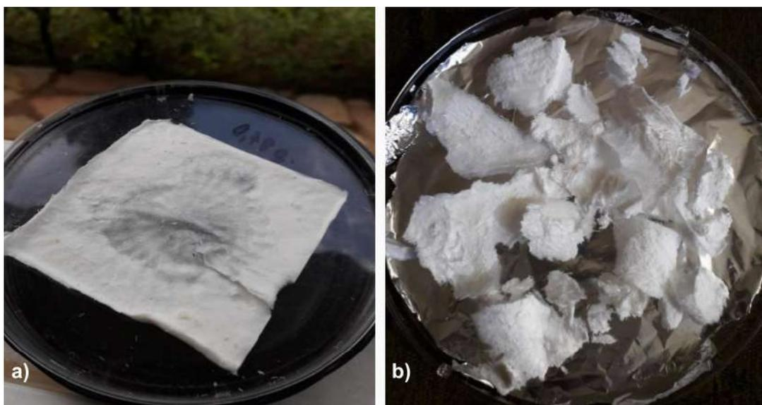
Figura 55: **a)** Amostra da folha de celulose filtrada a vácuo; **b)** Amostras deformadas durante a retirada do filtro
