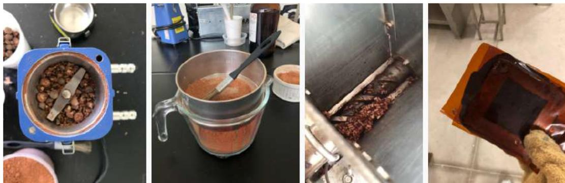
Figura 28: Etapas do processamento dos compósitos de PLA/Caroço de açaí
