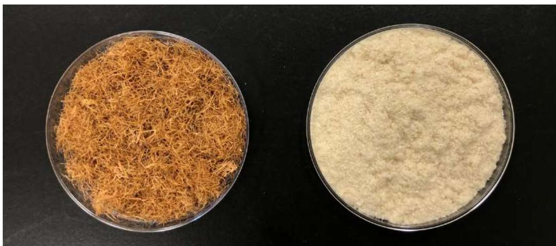
Figura 52: Amostras da fibra de açaí *in natura* e amostras da fibra branqueada
