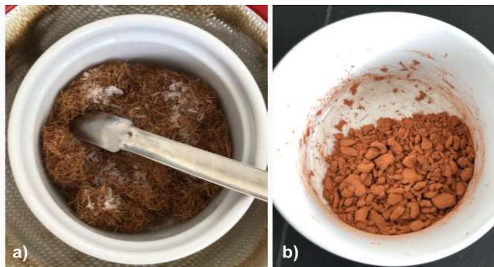
Figura 26: Processo de mistura do PEG com os resíduos de açaí (a - Fibras; b - Caroço)
