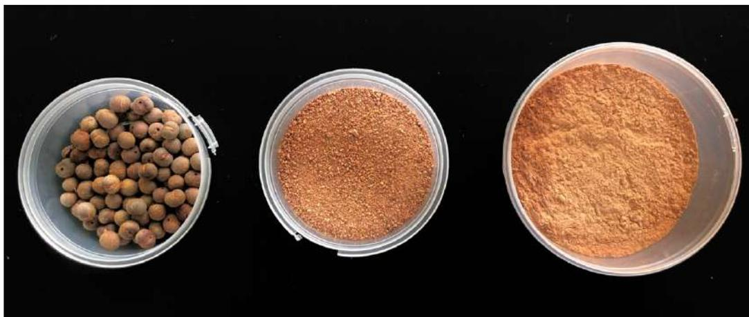
Figura 42: Processo de moagem do caroço de açaí
