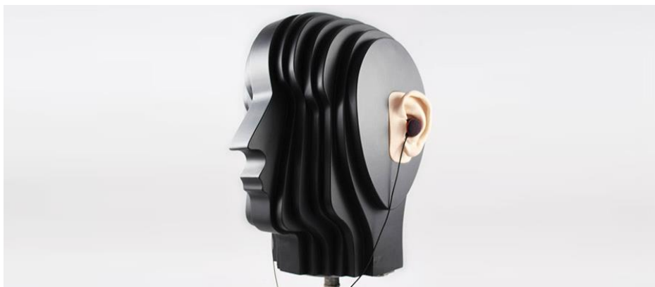
Figura 3. modelo de uma Dummy Head – simulação de uma gravação binaural 19
